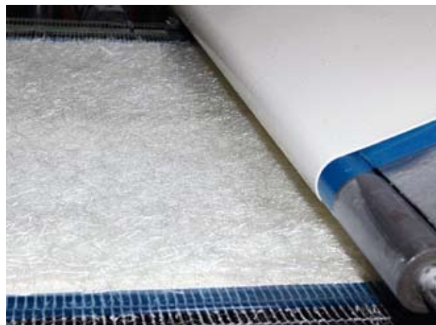
U podstaw przewagi konkurencyjnej naszych odwodnień leży zastosowanie tworzywa GFK w formie kompozytu SMC z dużym udziałem włókna szklanego.
